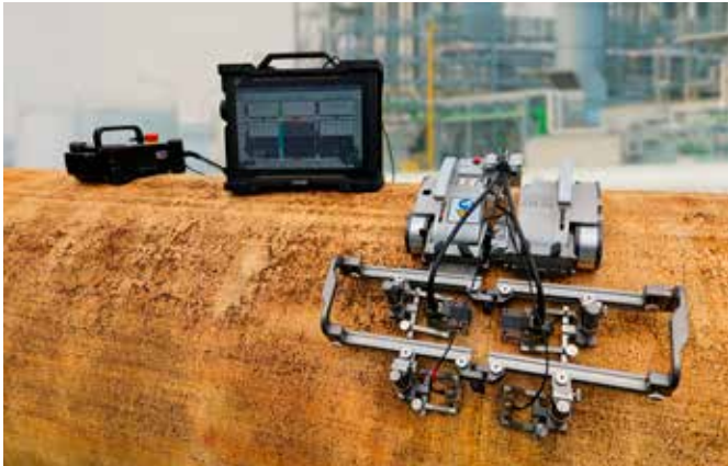
図2：モータのソフト制御内蔵 — Cypherは自動クローラーやロボティクスキャナと連携し、効率的な半自動検査を実現します。
