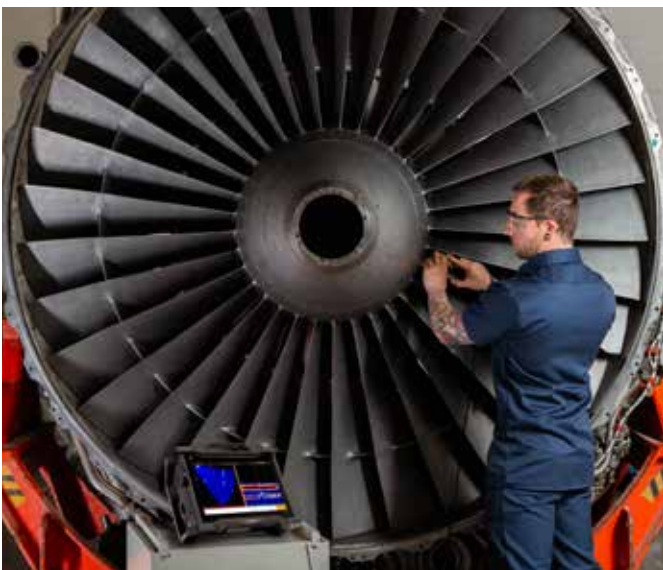
図3：Cypherによるタービン検査の様子。Eddyfi製の対応PAUTプローブとウェッジを使用。
