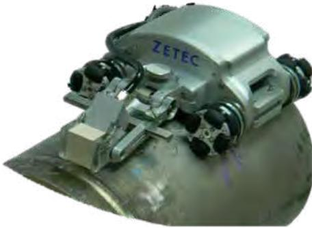
その革新的な設計の裏側には、内蔵する2軸エンコーダでX,Yスキャンを高精度に行い、複合材料向けには安全なノン・マグ・ホイールを、鉄鋼材料にはブレーキ機構付きのマグネット・ホイールを搭載でき、軸方向および横方向のどちらの固定モーションへ対応できるプローブサスペンション機構も備えます。
